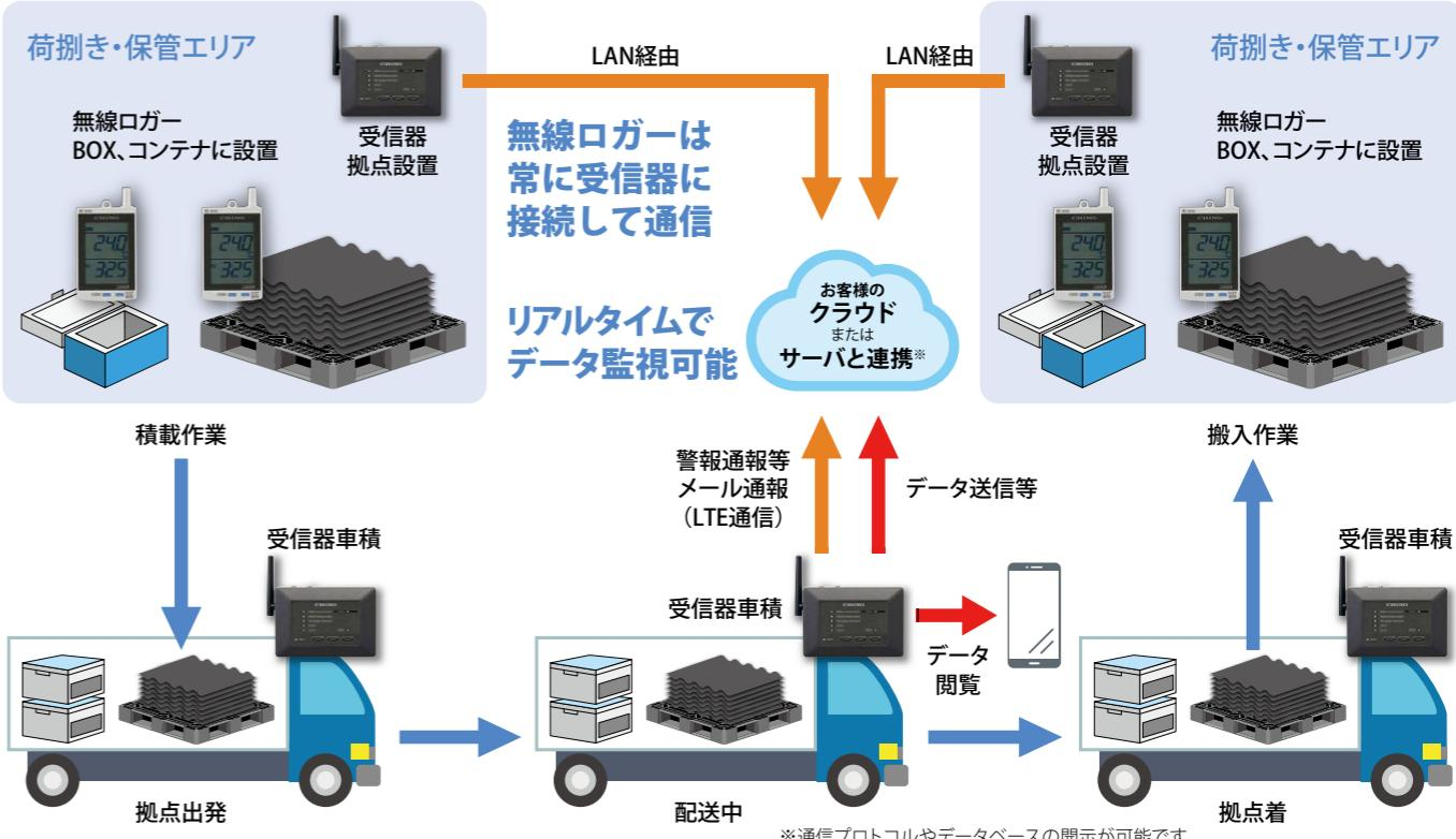
ロガーは**長距離通信モード・高速通信モード**どちらのモードの受信器にも接続が可能!
