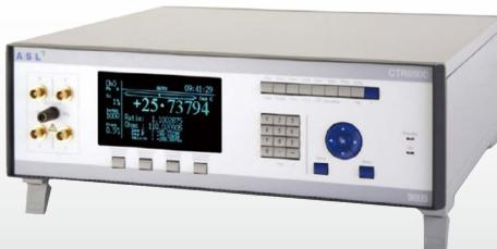
CTR6500は、測温抵抗体用のオートマチック交流抵抗ブリッジです。交流抵抗ブリッジの特長を生かし、優れた安定性、高分解能を実現しています。スイッチボックスを使用することにより、最大60点の入力も可能です。
