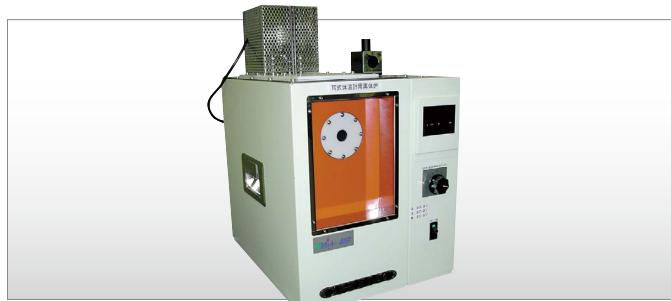
耳式体温計を高精度で校正するために産業技術総合研究所と共同開発した装置で、熱媒体に水を使用した循環式恒温槽形の黒体炉です。温度範囲は30~50°Cで基準温度測定には目盛校正された4線式白金測温抵抗体を使用します。
