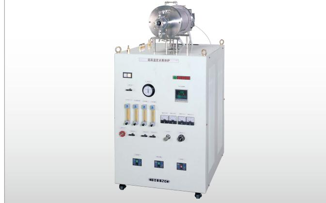
超高温定点黒体炉IR-R80シリーズは、産業技術総合研究所が開発した金属-炭素共晶点を用いた超高温定点黒体炉で、従来銅点(1085°C)までしか達成されていなかった放射温度計定点校正の高温化(2474°Cまで)を実現しました。装置は炉本体と定点るつぼから構成され、定点るつぼの交換により各種定点の実現が可能です。
