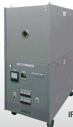
実用精密形比較黒体炉は、200°Cから3000°Cの温度範囲を3種類の黒体炉でカバーし放射温度計の校正を精密に行います。熱容量が大きく保温性がよいので、温度安定性、均熱性に優れています。
