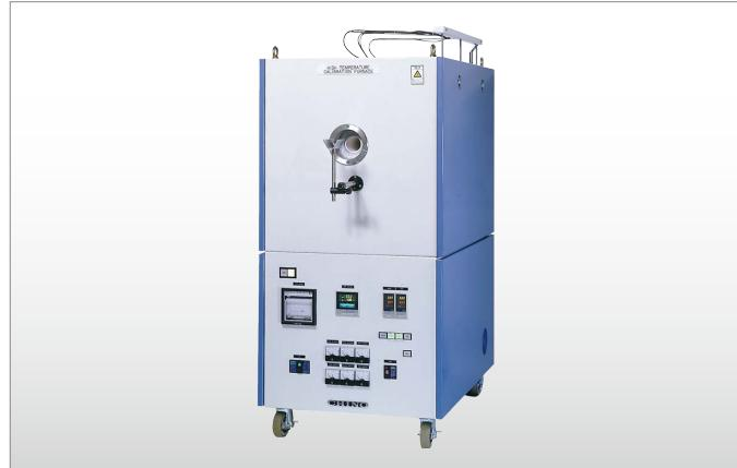
本装置は、校正温度範囲600°Cから1400°Cの熱電対用温度比較校正装置です。口径60mmの横形管状炉を使用し、3ゾーン分割制御をしているため安定性に優れ、また均熱長が長いため良好な温度分布を実現します。
