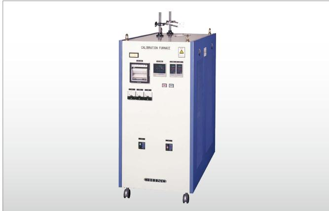
本装置は、校正温度範囲200°Cから1100°Cの熱電対用の温度比較校正装置です。口径80mmの縦形管状炉を使用し、3ゾーン分割制御をしているため安定性および温度分布に優れています。口径が大きいため保護管径の大きいセンサの校正も可能です。標準R熱電対C800-35や、測定ユニットも用意しています。(別売)
