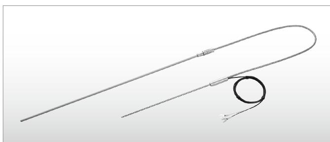
C820は産業技術総合研究所からの技術移転により商品化された高純度の白金(+脚)とパラジウム(-脚)を用いた標準熱電対です。C850は玉川大学工学部後藤教授との共同研究により商品化された高純度の金(+脚)と白金(-脚)を用いた標準熱電対です。JIS C1602(IEC60584)に規定する貴金属熱電対(R,S,B)を用いた従来のを用いた従来の熱電対に比べ、高温での安定性が格段に向かっています。
