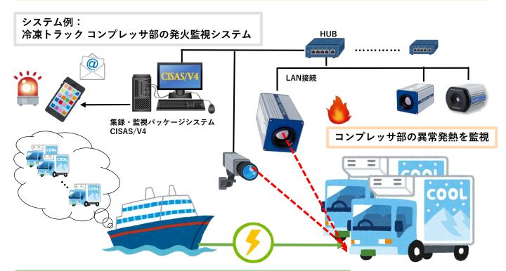
船から冷凍トラックのコンプレッサ部へ電源供給し、冷凍温度を保持
