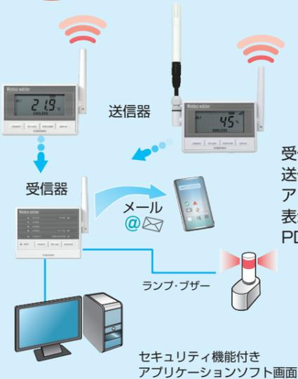
受信器 1 台で送信器 60 台 (最大受信器 6 台で送信器 360 台) を無線でデータ集録します。アプリケーションソフトは、グラフィックモニタ表示や日報・月報・レポート作成ができます。PDF ファイル出力、電子署名が可能。
