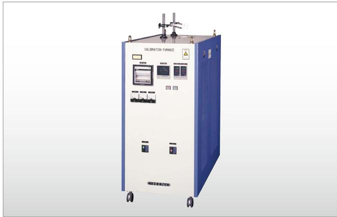
本装置は、校正温度範囲200℃から1100℃の熱電対用の温度比較校正装置です。口径80mmの縦形管状炉を使用し、3ゾーン分割制御をしているため安定性および温度分布に優れています。口径が大きいため保護管径の大きいセンサの校正も可能です。標準R熱電対C800-35や、測定ユニットも用意しています。(別売)
