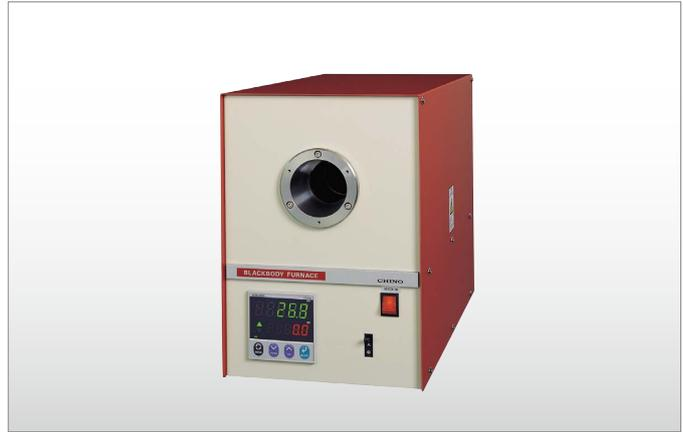
工業技術院計量研究所(現:産業技術総合研究所)と共同で開発した放射温度計校正用の大開口黒体炉です。
