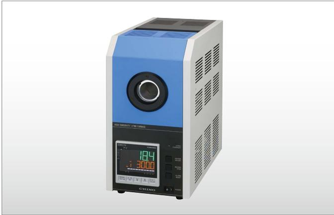
産業技術総合研究所との共同研究で開発した放射温度計を比較校正するための温度可変黒体炉です。
