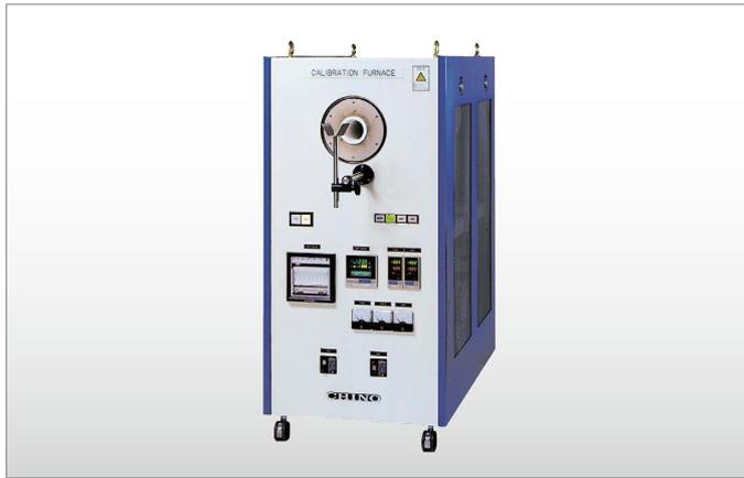
本装置は、熱電対の温度比較校正装置で、校正温度範囲は200℃から1100℃です。口径60mmの横形管状炉を使用し、3ゾーン分割制御をしているため安定性および温度分布に優れています。標準R熱電対C800-35や、測定ユニットも用意しています。(別売)
