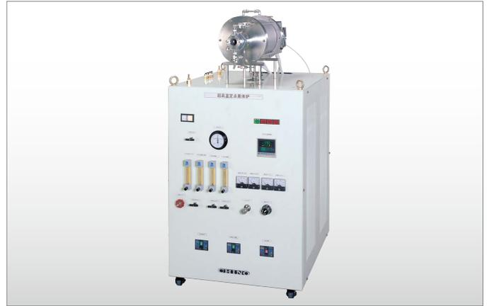
超高温定点黒体炉IR-R80シリーズは、産業技術総合研究所が開発した金属-炭素共晶点を用いた超高温定点黒体炉で、従来銅点(1085℃)までしか達成されていなかった放射温度計定点校正の高温化(2474℃まで)を実現しました。装置は炉本体と定るつばから構成され、定るつばの交換により各種定点の実現が可能です。
